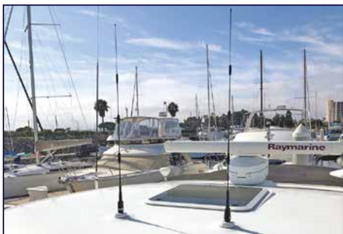
Le antenne in stile Hamstick per VHF e UHF, montate su misura sul tetto della barca.
