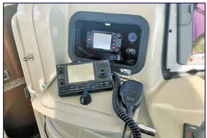
La radio Yaesu FTM-400 VHF e UHF montata in un "glove box" impermeabile.
