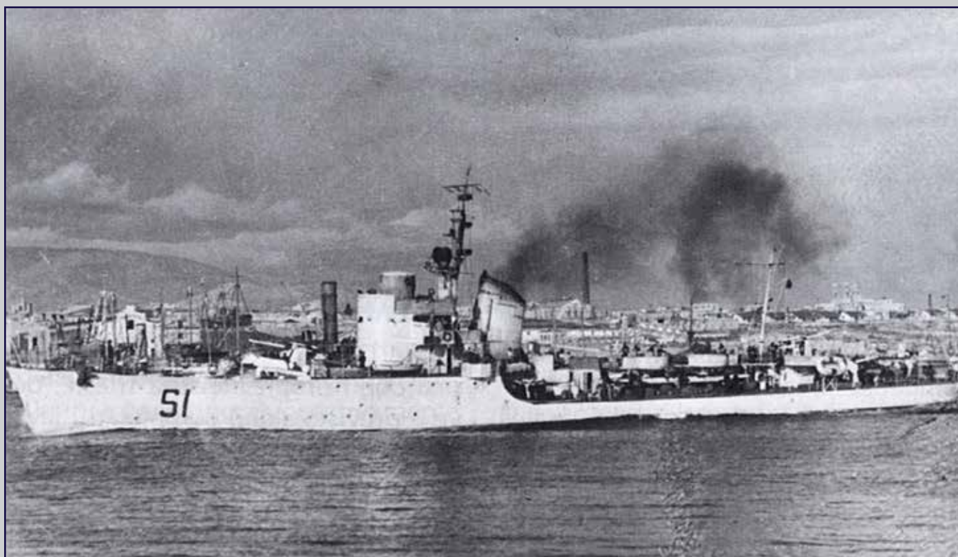
La Sirio in partenza dal Pireo per scortare un convoglio a Suda, il 28 dicembre 1941; è visibile la nuova configurazione dei tubi lanciasiluri, adottata nell'estate 1941 (g.c. STORIA militare)
