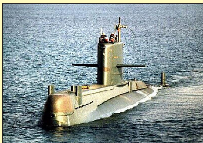
Sottomarino Sauro; in vista le 6 pinne del misuratore passivo della distanza, in alto a prua, di colore diverso dal resto dello scafo, la calotta idrodinamica che copre la base ricevente cilindrica del sonar IPD70S
